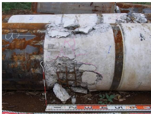
曲げ試験(試験後状況)
