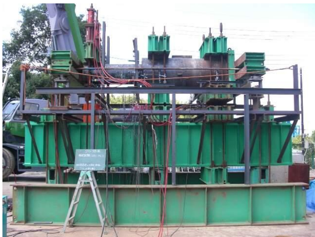
曲げ試験(載荷装置全景)
